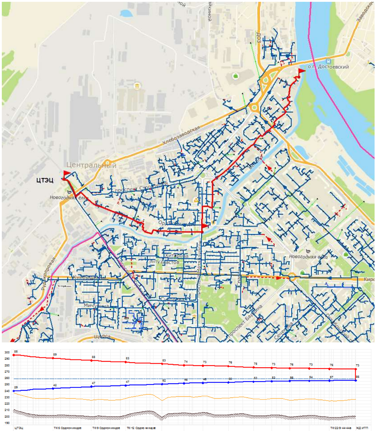
Рисунок 3.7 – Пьезометрический график магистрали ЦТЭЦ по ул. Орджоникидзе после подключения перспективных потребителей
